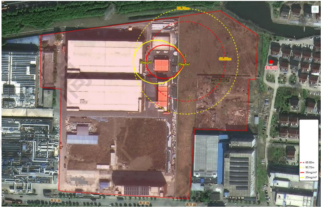
图 6.1-4 本项目氟碳树脂泄漏事故影响范围图（最不利条件）
