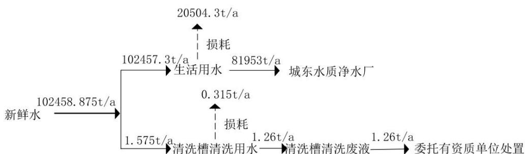
图2-11 现有项目水平衡图
