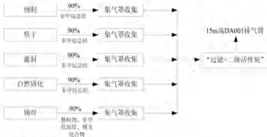
图 4-1 本项目废气处理系统图
