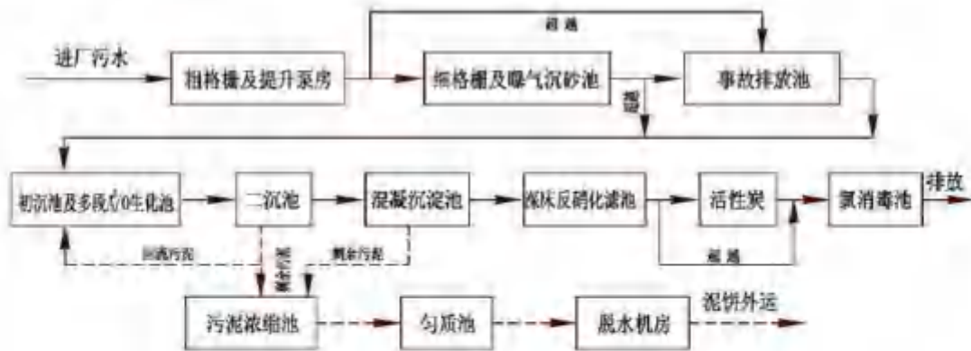
图 4-2 城东水质净化厂污水处理工艺流程图
